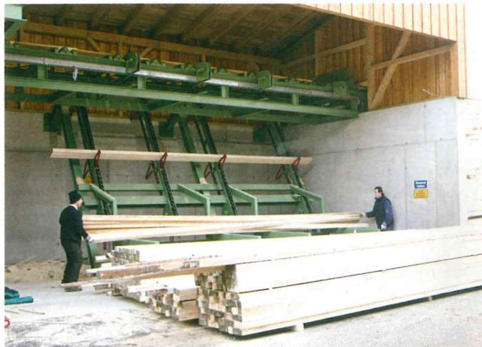
**Langes Bauholz wird hinter der Nachschnitt-Kreissäge manuell gepapelt**
