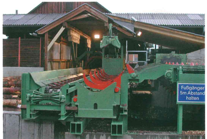
Vor kurzem wurde bei Prehofer die Rundholzaufbringung erneuert – jetzt ist man speziell auf starkes Holz ausgelegt
