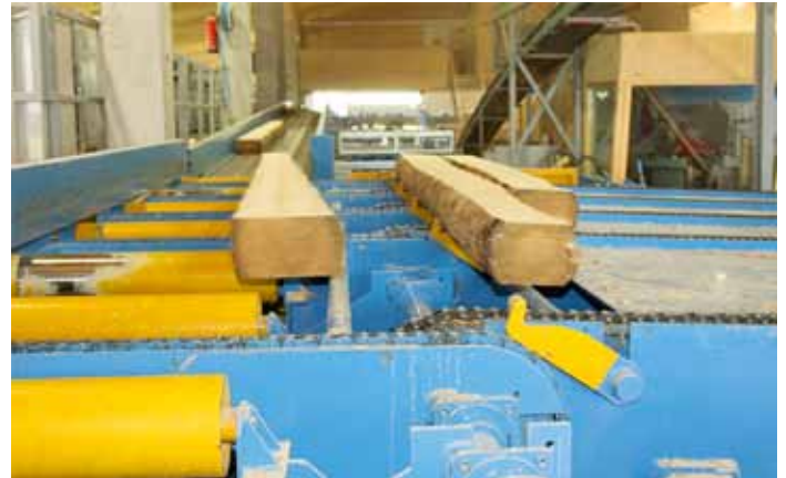
Rundlauf: Die Model werden auf dem Querförderer separiert und über ein Förderband und einen weiteren Querförderer wieder der Linie zugeführt
