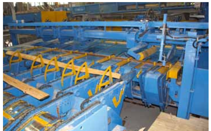
Manipulationsbereich der Optimes-Line: Bediener kann die Ware wenden und vor dem Rollengang bei Bedarf Störschwarten mittels Klappe ausschleusen
