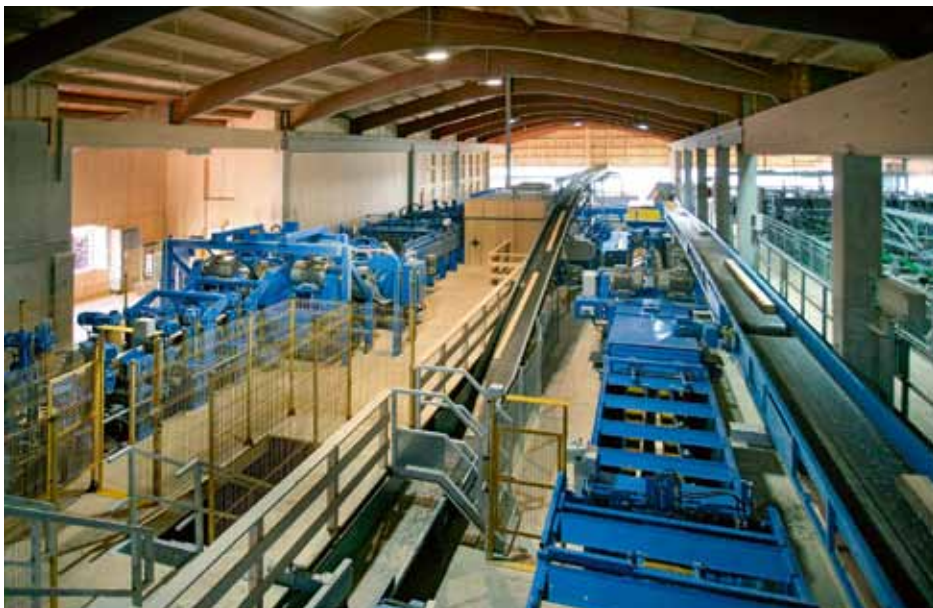
Reduzier-Kreissägenlinie vom Typ „ReducerLine“ auf kleinstem Raum im Rundlauf mit hoher Flexibilität und einer Schnittbild-Optimierung von Stamm zu Stamm
