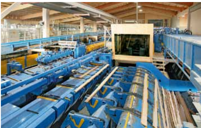
Blick auf Optimes-Line-Bedienkabine, mittig der Manipulationsbereich, folgend von Einzugstisch, Vermessung, Zwischenstrecke und Besäumkreissäge
