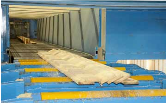
Auszug der Hauptware hinter der Reduzier-Kreissägenlinie: Die Ware wird zur Schnittholzsortierung aus dem Rundlauf geschleust
