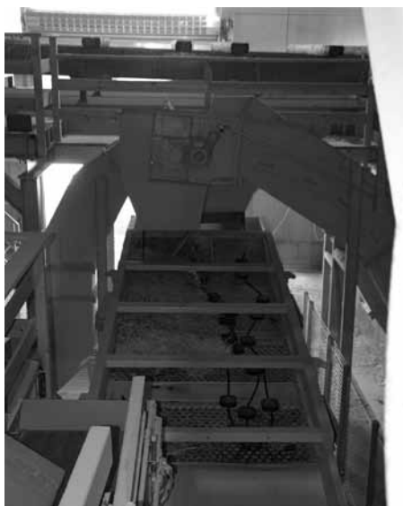
Schwingsichter von Rudnick & Enners mit drei Fraktionen auf 7,5 m 2 Siebfläche
